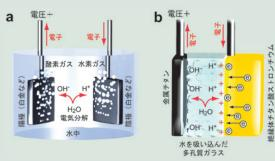
図1 水の電気分解によるチタン酸ストロンチウム表面の金属化 (a) 水の電気分解では、水中に入れた2枚の金属板に電 圧を加えることで水を水素と酸素に分解します。
