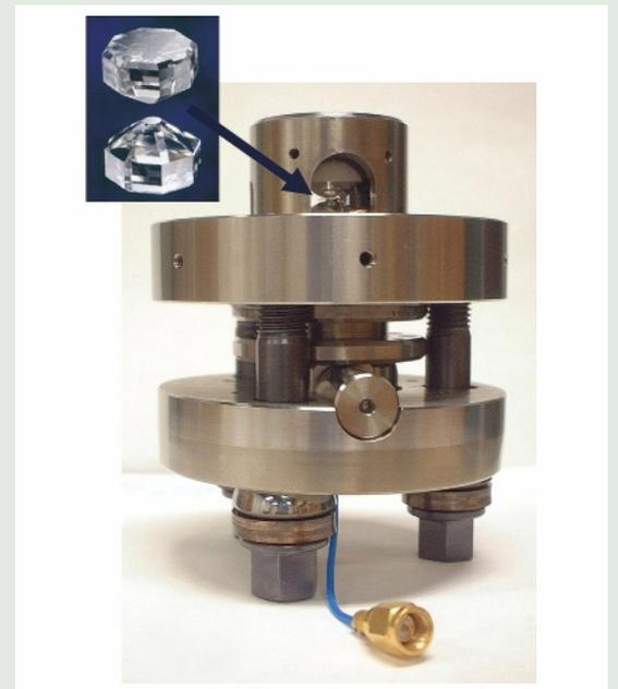
図1 NMR用超高压力発生装置
