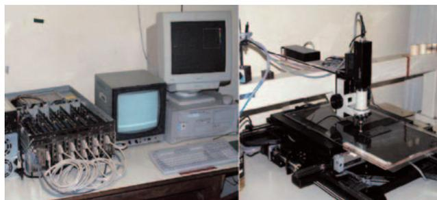
写真1 飛跡自動読み取り装置 右方に高速カメラ(毎秒3000画面)を装着した顕微鏡、左方には自作の並列コンピューターが見える。
