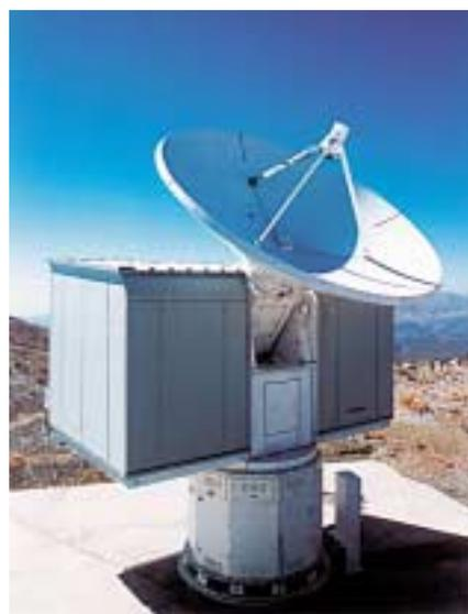
図2 ラスカンパナスに設置された「なんてん」電波望遠鏡。主鏡の口径は4メートルである。
