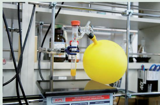
写真1 有機反応の様子。一般的には反応容器(フラスコや試験管)の中で原料を溶媒に溶かし、反応剤を加えることで有機反応を行う。空気中の水や酸素の影響を排除するために、不活性ガス雰囲気下で反応を行うことが多い(風船にはアルゴンが満たされている)。反応容器に入れた攪拌子を、マグネチックスターラー(反応容器の下の装置)にて磁力を用いて回転させることで、反応溶液を攪拌することができる。
