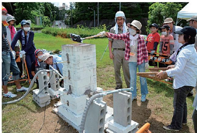
たたら製鉄実験の様子
