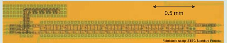
図2 従来の1/100に消費電力を削減した単一磁束量子回路（8ビットシフトレジスタ）。20ギガヘルツ以上の動作を確認。
